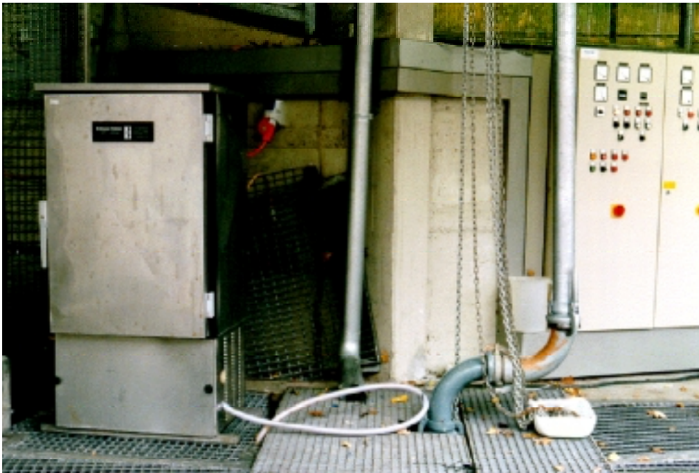
Versuchspumpe und Probennehmer bei Durchführung der Versuche mit direkter Entnahme des Mischwassers
