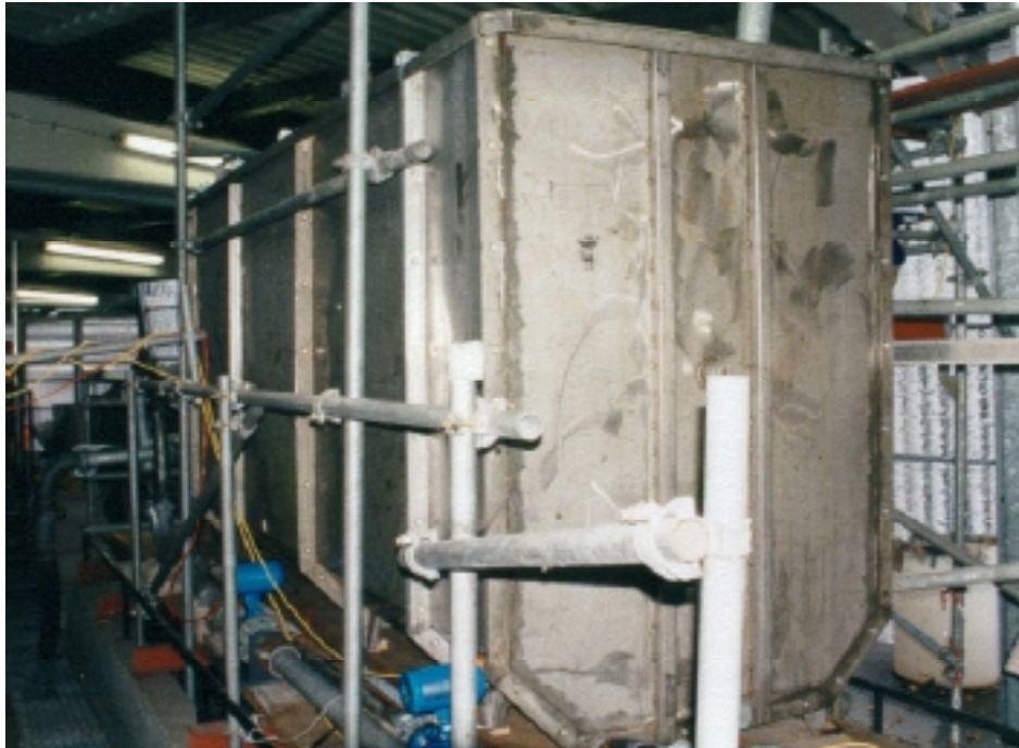
Versuchsbecken zur Untersuchung von Fällung und Flockung des Mischwassers
