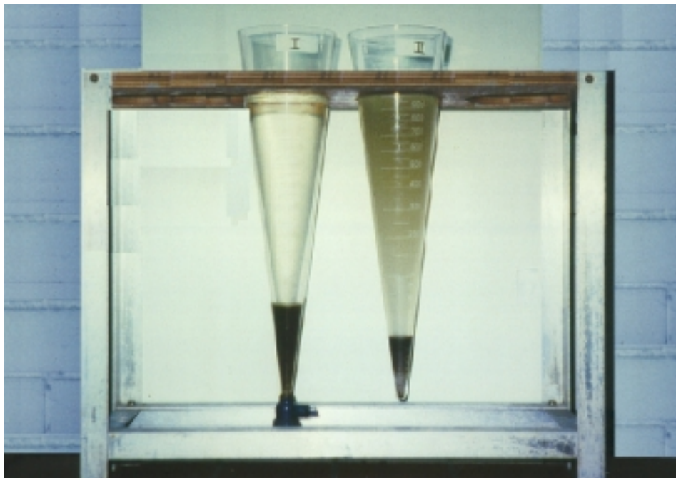
Abb. 7: Vergleich des Absetzverhaltens der Partikel im Mischwasser ohne und mit Fällung/Flockung: links – mit Fällung/Flockung, rechts – ohne Fällung/Flockung
